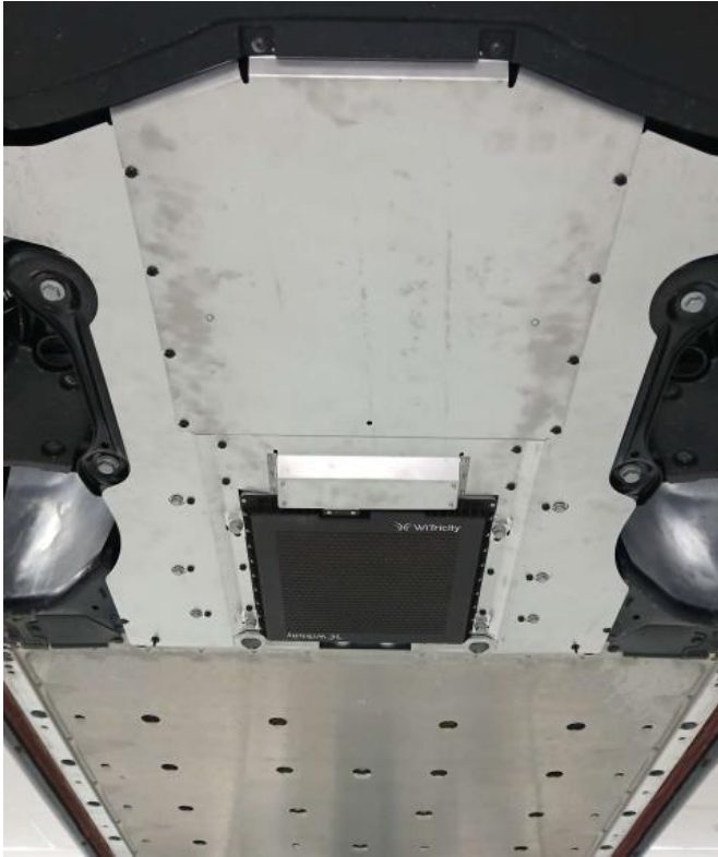
Abbildung 30: Installierte Fahrzeugeinheit (VA) am Unterboden
