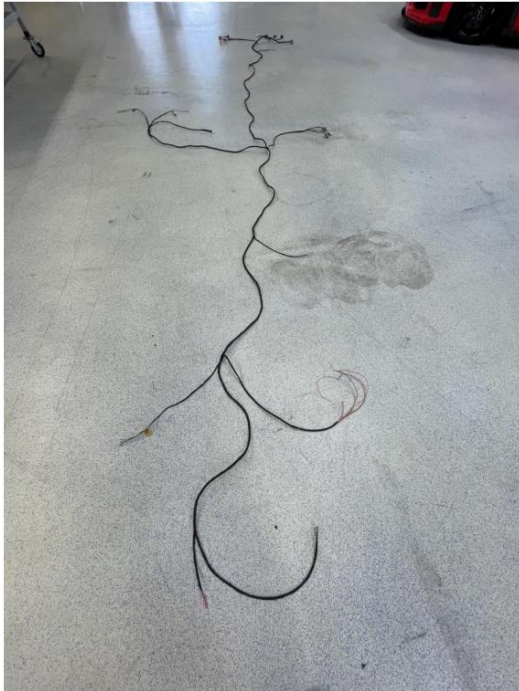
Abbildung 18: Kabelbaum Niedervoltsystem (12 V) vor Fahrzeuginstallation
