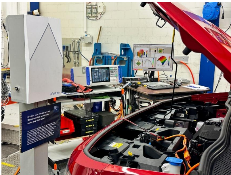
Abbildung 48: Effizienzmessungen im Labor der Empa
