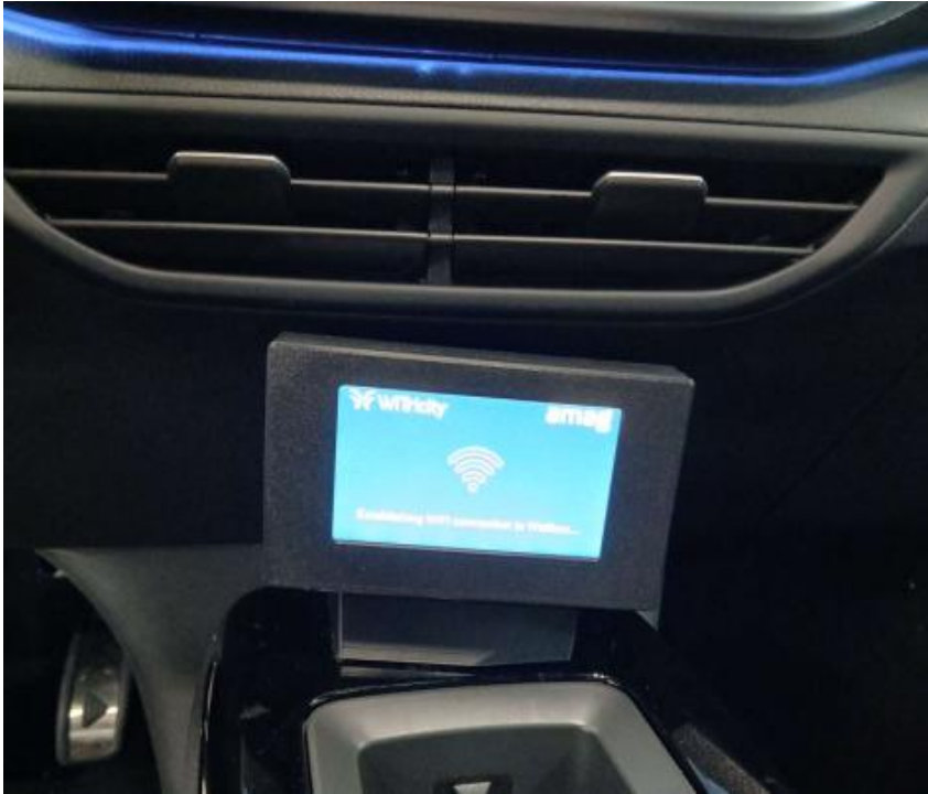
Abbildung 32: Display zur Visualisierung der Einparkhilfe auf Mittelkonsole
