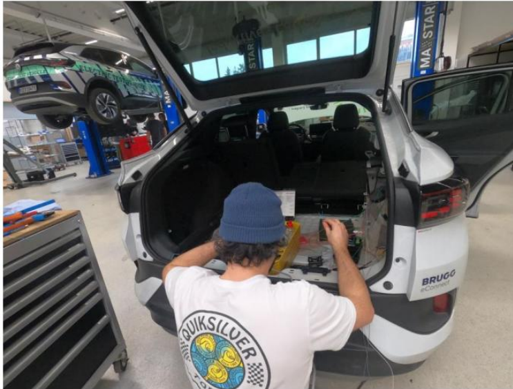
Abbildung 20: Installation Kabelbaum im hinteren Fahrzeugbereich
