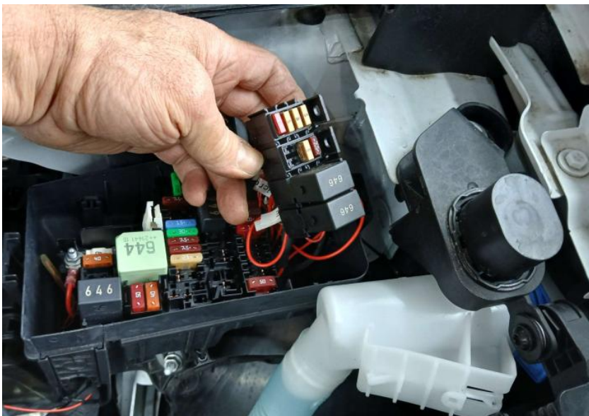
Abbildung 35: Zusätzliche Sicherungshalter im vorderen Sicherungskasten
