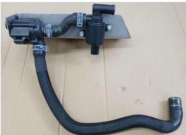
Abbildung 31: Neue Halterung der Kühlmittelpumpe und des Magnetventils
