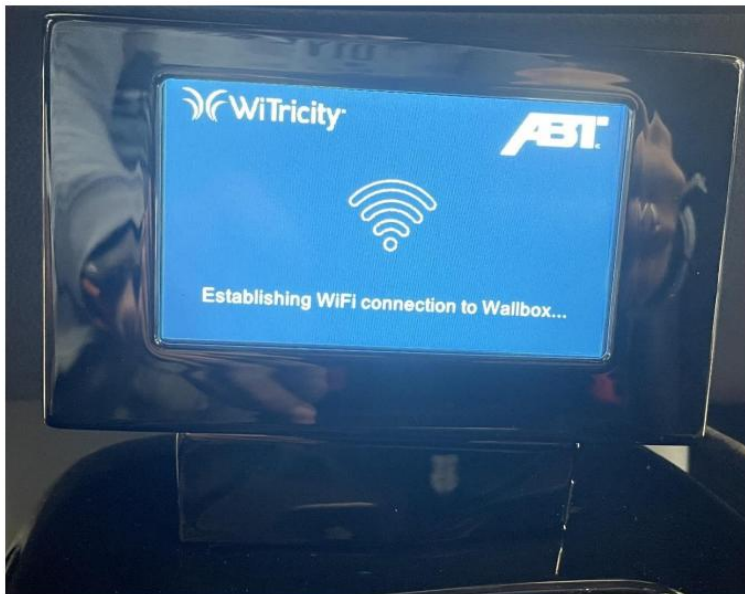
Abbildung 21: Zusätzliches Display zur Visualisierung des Systemzustands
