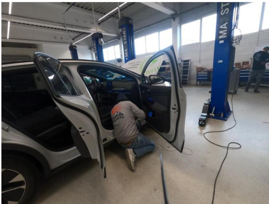
Abbildung 19: Installation Kabelbaum im Fahrzeuginneren
