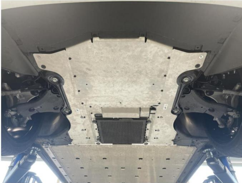
Abbildung 16: Fertig installierter Unterboden inkl. Schirmbleche
