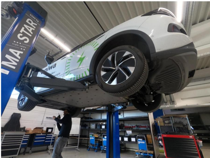
Abbildung 11: Demontage Unterbodenabdeckung vorne
