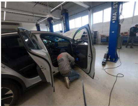
Abbildung 18: Installation Kabelbaum im Fahrzeuginneren
