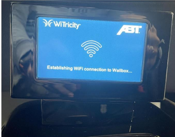
Abbildung 20: Zusätzliches Display zur Visualisierung des Systemzustands
