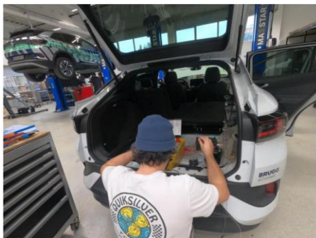
Abbildung 19: Installation Kabelbaum im hinteren Fahrzeugbereich
