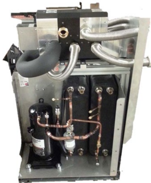
Abbildung 22: Innenansicht der eingesetzten Niedertemperaturhub-Wärmepumpe.
