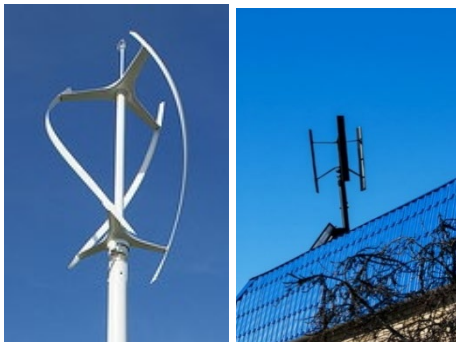
Abbildung 3: Beispiele für Vertikalachsenanlagen. Links: Darrieus-Rotor (Foto: www.klein-windkraftanlagen.com ). Rechts: H-Rotor (Foto: iStock)
