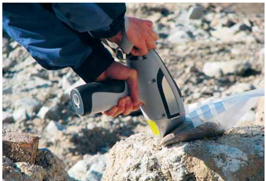
Messung des Bleigehalts mit mobiler Röntgenfluoreszenz-Spektrometrie (m-XRF) im Feinanteil der aufbereiteten Probe.
