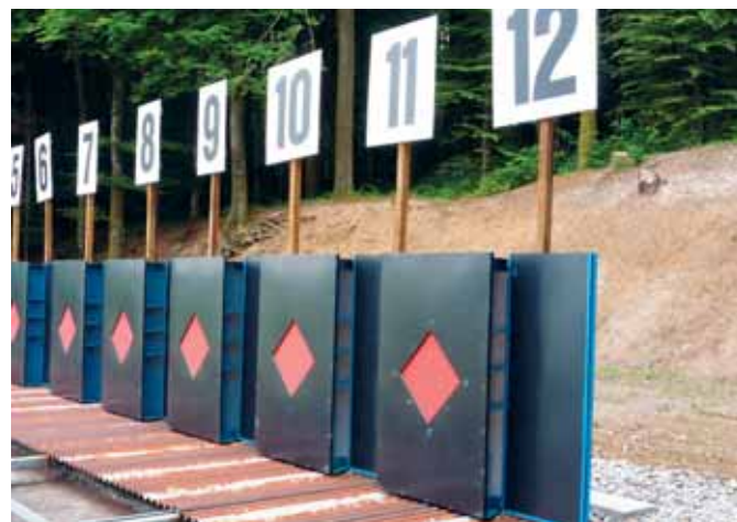
Nach dem Stand der Technik umgerüstete Schiessanlagen in Wetzikon (links) und Fehraltorf (rechts) mit emissionsfreien künstlichen Kugelfängkästen.
