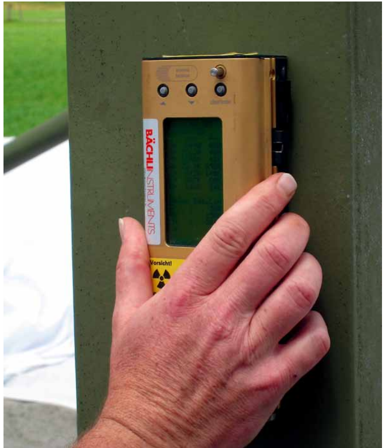
Schwermetallanalyse mit einem portablen Röntgenfluoreszenzgerät am Objekt.
