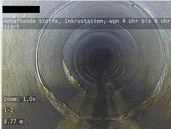
Foto 18: geringe Inkrustation an Rohrstößen
