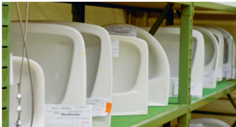
Neuwertig aufbereitet warten die Bauteile, hier Lavabos, auf ihren neuen Einsatz. Quelle: Stiftung Chance
