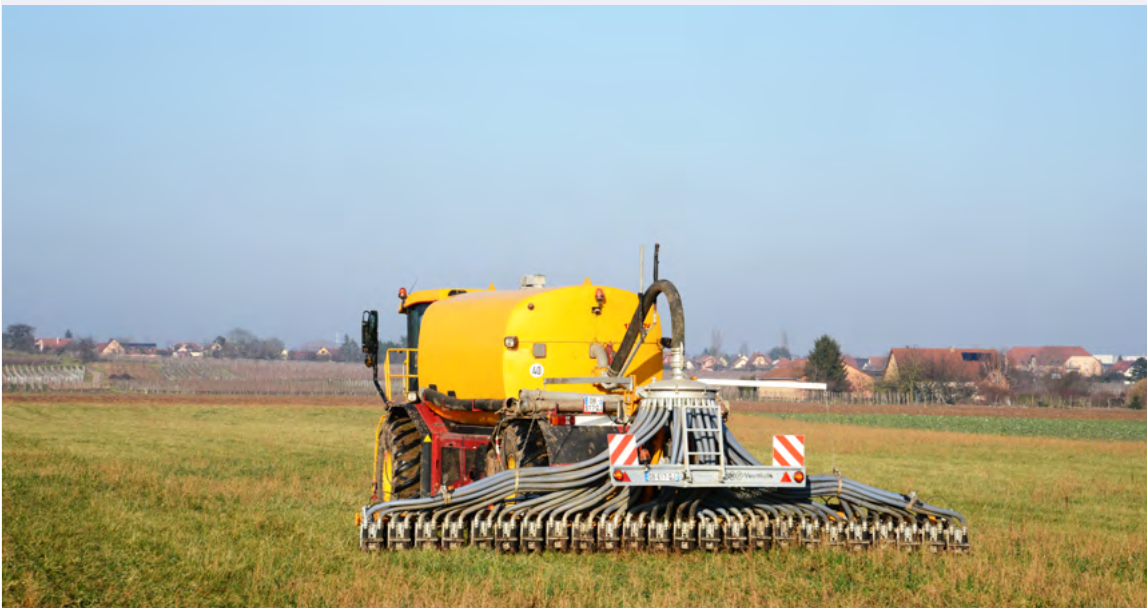
Foto 6.3: Mit dem Gülledrillverfahren wird das flüssige Vergärungsprodukt in den Oberboden abgelegt. Damit wird die Ammoniakverflüchtigung meistens stark reduziert.
