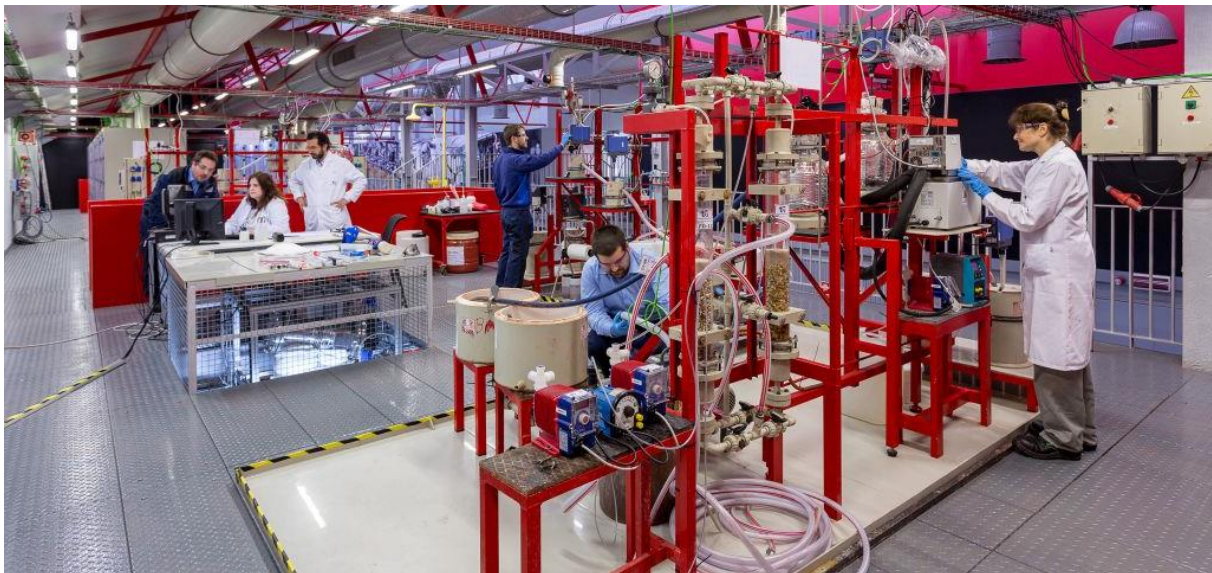
Abbildung 5: Im Vordergrund die zweistufige KSA-Laugung und Filtration. Im Hintergrund sind die beiden Einhausungen der Eisen- und Phosphorsäure-Solventextraktionen zu sehen.
