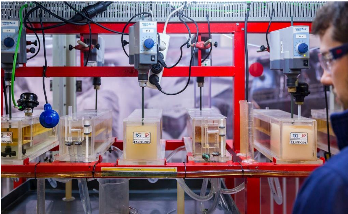
Abbildung 7: Ausschnitt der Eisen-Solventextraktion, die exemplarisch den Einsatz der verwendeten Mischer-Scheider-Einheiten zur Phasenkontaktierung zeigt.
