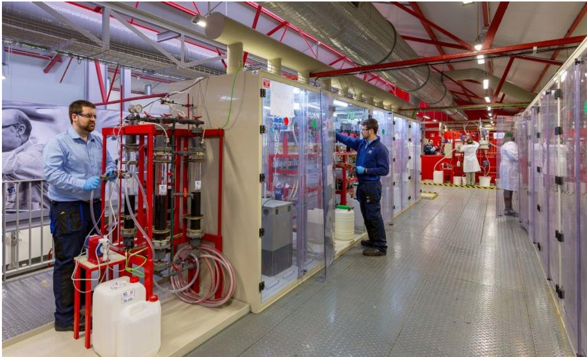
Abbildung 6: Phosphor-Solventextraktion (rechts) und Eisen-Solventextraktion (links) in den Kunststoffeinhausungen untergebracht und am zentralen Abluftsystem angeschlossen.
