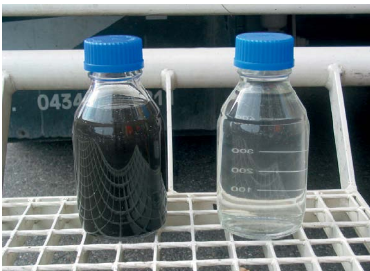
Links: Unbehandeltes Abwasser aus Strassensammlern. Rechts: Mobil aufbereitetes Abwasser.
