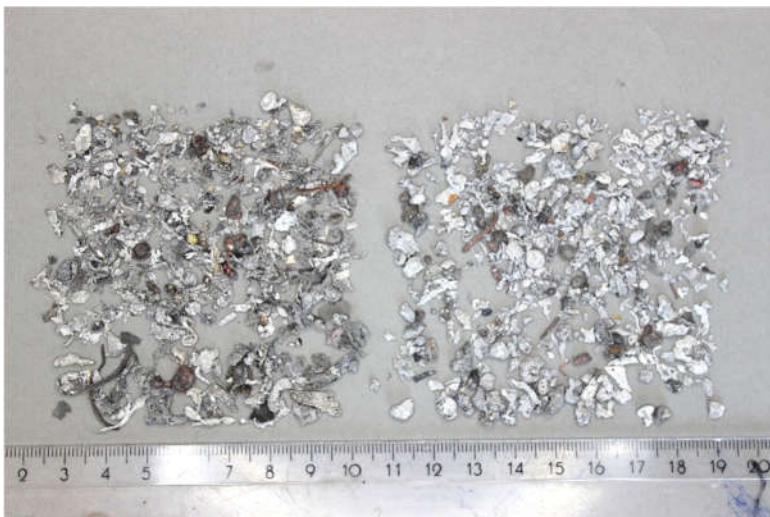
Abb. 20: NE-Metall 1-5 mm im Vergleich. links aus einer Trockenschlackenprobe (ERZ B), rechts aus einer Nassschlackenprobe (Winterthur A).
