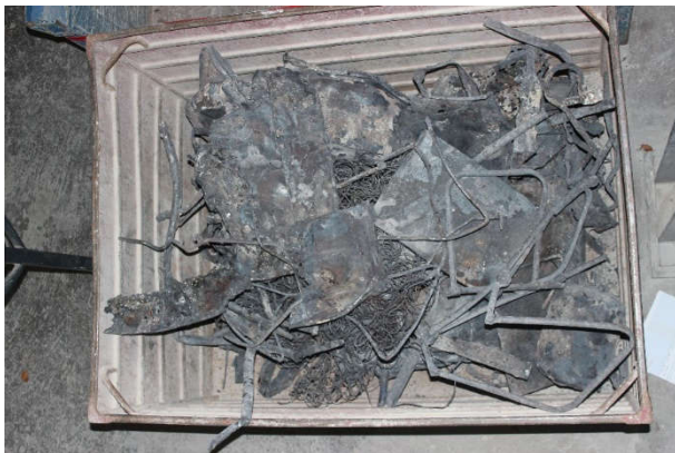
Abb. 7: Grobteile aus der Schlacke der KVA Horgen vom zweiten Sortiertermin am Ende der Probenahmekampagne.
