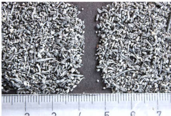
Abb. 50 a und b: Die NE-Fraktion 0,5-1 mm gewonnen durch nachträgliche Siebung der NE-Metalle 1-5 mm aus der ZAR-Analyse (Material aus Limeco-Schlacke). Links das Material aus der Variante mit Nasssiebung, rechts aus der Trocknung.
