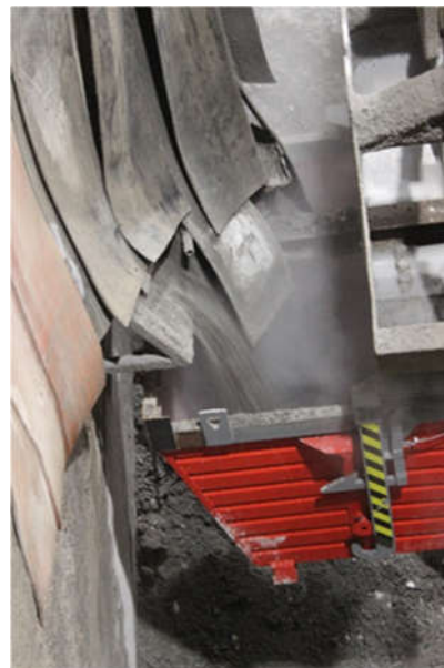
Abb. 12a und b: Probenahme am Abwurf des Schlackenbandes von Verbrennungslinie 1 der KVA Winterthur mit dem am Schlackenkran angehängten Probenahme-Container. links (a): Probenahmecontainer am Kran; rechts (b): während des Auffangens von Probenmaterial.
