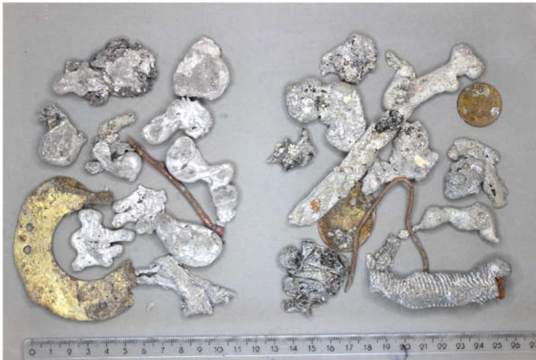
Abb. 15: NE-Metall >16 mm im Vergleich. links aus Trockenschlackenprobe (ERZ B), rechts aus Nassschlackenprobe (Winterthur A).
