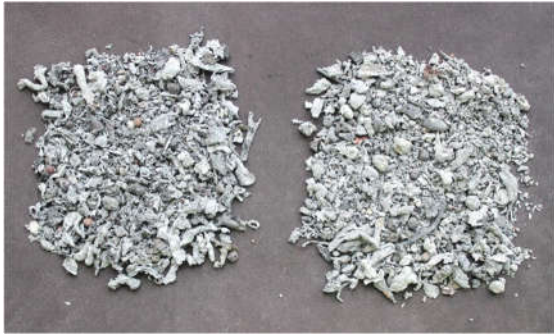
Abb. 48 a und b: Die NE-Fractionen 1-5 mm der ZAR-Analyse aus den Proben der Limeco-Schlacke. Links das Material aus der Variante mit Nasssiebung, rechts aus der Trocknung.
