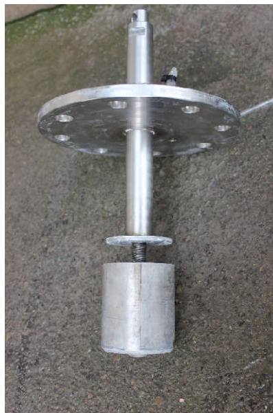
Abb. 62a und b: Spezialbehälter zur Simulation der Bedingungen beim Nassentschlackerdurchgang. (Planung und Ausführung: KVA Winterthur) links: der gesamte Behälter; rechts: der innere Teil mit dem Zylinder für die Versuchsmischung und der Spindel zum Pressen.
