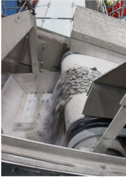
Abb. 3a und b: Probenahme an der Probenahmestation bei der ZAV Recycling AG. links (a): Entnahmevergung, rechts (b): Entleerung des Sammelgefäßes durch Öffnen an der Bodenklappe.
