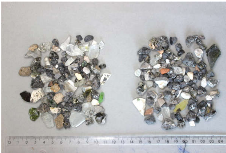
Abb. 22: aufbereitete Schlacken 5-16 mm aus der Analyse mit der ZAR-Methode im Vergleich. links aus einer Trockenschlackenprobe (ERZ B), rechts aus einer Nassschlackenprobe (Winterthur A).
