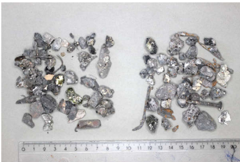
Abb. 23: magnetische Schlacken 5-16 mm aus der Analyse mit der ZAR-Methode im Vergleich. links aus Trockenschlackenprobe (ERZ B), rechts aus Nassschlackenprobe (Winterthur A).
