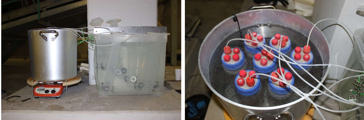
Abb. 60a und b: Einfacher Aufbau zum Thermostatisieren der Versuchsansätze und zur Messung des Gasvolumens. Kochtopf auf Magnetrührer und die Messzylinder überkopf im Wasserbad (links), die Reaktionsgefäße im Wasserbad bei 70°C (rechts).
