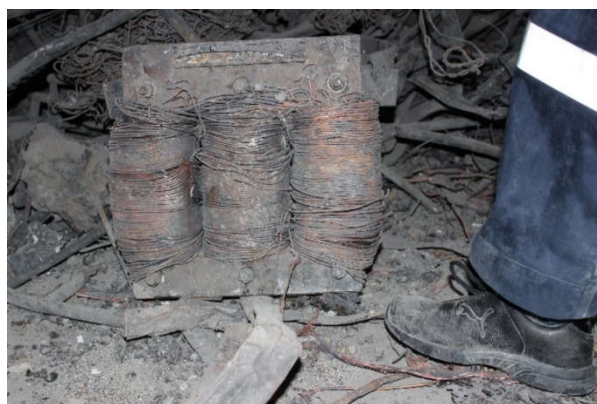
Abb. 6a und b: Greiferladung an Grobteilen beim Räumen des Bunkers (a links) und Drosselspule als NE-Metall-Träger (b rechts).
