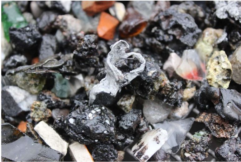
Abb. 96: Detailaufnahme eines Alu-Metall-Korns in einer sofort nassgesiebten Schlackenprobenfraktion 4-8 mm.
