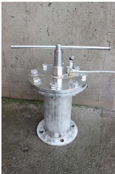
Abb. 62a und b: Spezialbehälter zur Simulation der Bedingungen beim Nassentschlackerdurchgang. (Planung und Ausführung: KVA Winterthur) links: der gesamte Behälter; rechts: der innere Teil mit dem Zylinder für die Versuchsmischung und der Spindel zum Pressen.
