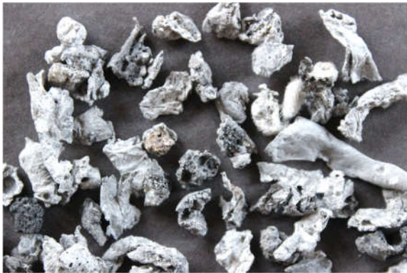
Abb. 46: NE-Metalle aus der ZAR-Analyse. Blanke Metallkörner und Körner mit Schlackenanhaftungen (Bildmitte und linke untere Ecke. (hier das NE-Metall 4-5 mm aus der Nassgesiebten Probe Winterthur, September 2022; Zufallsauswahl der Körner)
