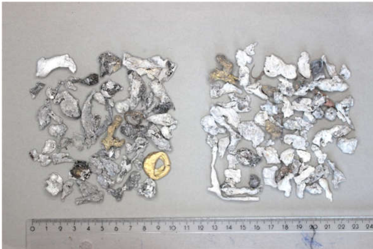
Abb. 19: NE-Metall 5-16 mm im Vergleich. links aus einer Trockenschlackenprobe (ERZ B), rechts aus einer Nassschlackenprobe (Winterthur A).
