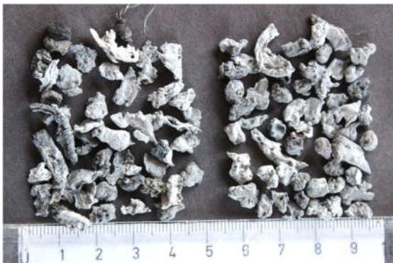
Abb. 49 a und b: Die NE-Fractionen 4-5 mm der ZAR-Analyse aus den Proben der Schlacke von KVA Winterthur. Links das Material aus der Variante mit Nasssiebung, rechts aus der Trocknung.
