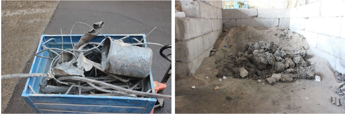
Abb. 8a und b: Metalle (a links) und Sinterschlackenbrocken (b rechts) aus den Grobteilen KEZO.
