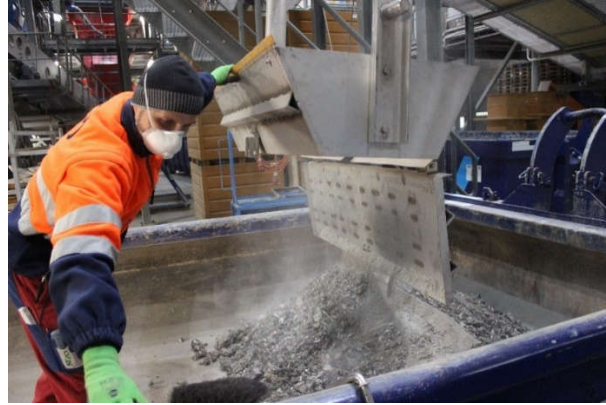
Abb. 3a und b: Probenahme an der Probenahmestation bei der ZAV Recycling AG. links (a): Entnahmevergung, rechts (b): Entleerung des Sammelgefäßes durch Öffnen an der Bodenklappe.
