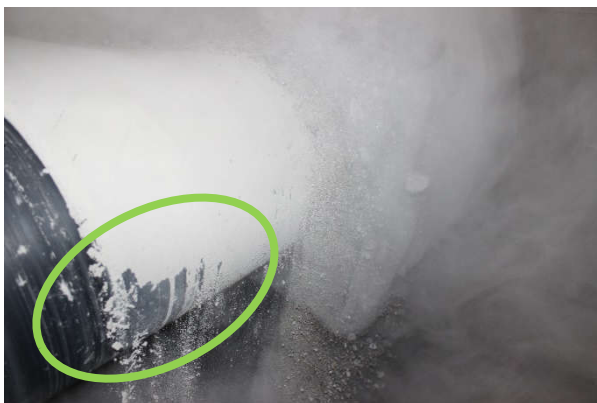
Abb. 5: Bandabwurfstelle in der Probenahmestation. Staub löst sich vom Band noch vor dem Scheitelpunkt.
