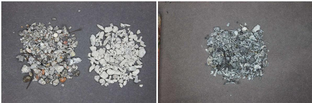
Abb. 16a und b: linkes Bild (a): NE-Metall 1-5 mm, Gebr. Lienhard AG nach dem Waschen (linkes Häufchen) und vor dem Waschen (rechtes Häufchen); rechtes Bild (b): NE-Metall 1-5 mm, ZAV Recycling AG.
