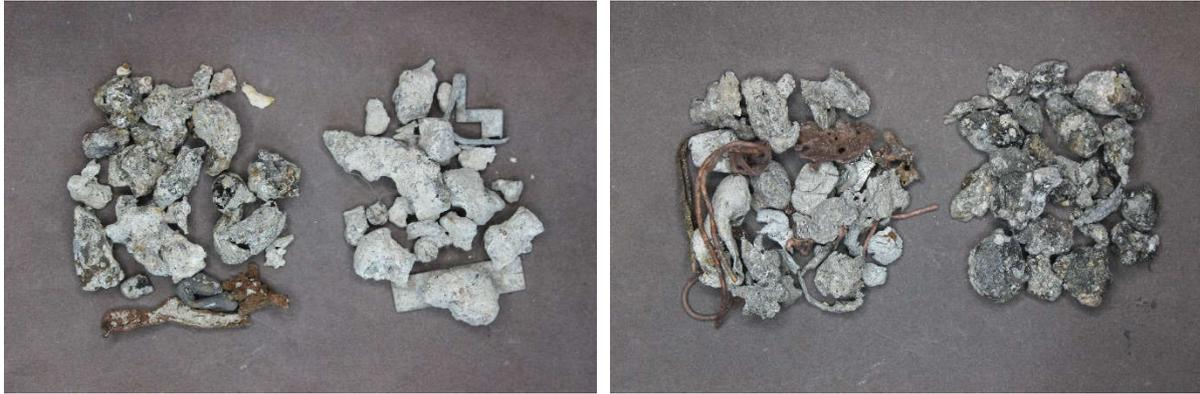
Abb. 15a und b: linkes Bild (a): NE-Metall 5-16 mm, Gebr. Lienhard AG nach dem Waschen (linkes Häufchen) und vor dem Waschen (rechtes Häufchen); rechtes Bild (b): NE-Metall 5-16 mm, ZAV Recycling AG, saubere Körner (linkes Häufchen) und verschmutzte Körner (rechtes Häufchen).
