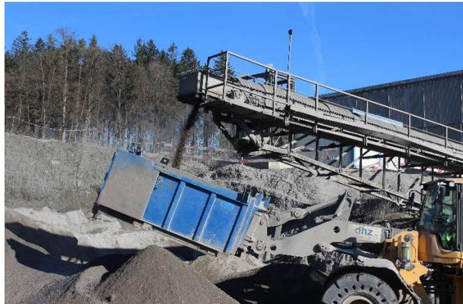
*Abb. 7a und b: Probenahmestelle beim Bandabwurf auf der Deponie (links). Probenahme mittels Radlader und Handling-Container (rechts).*
