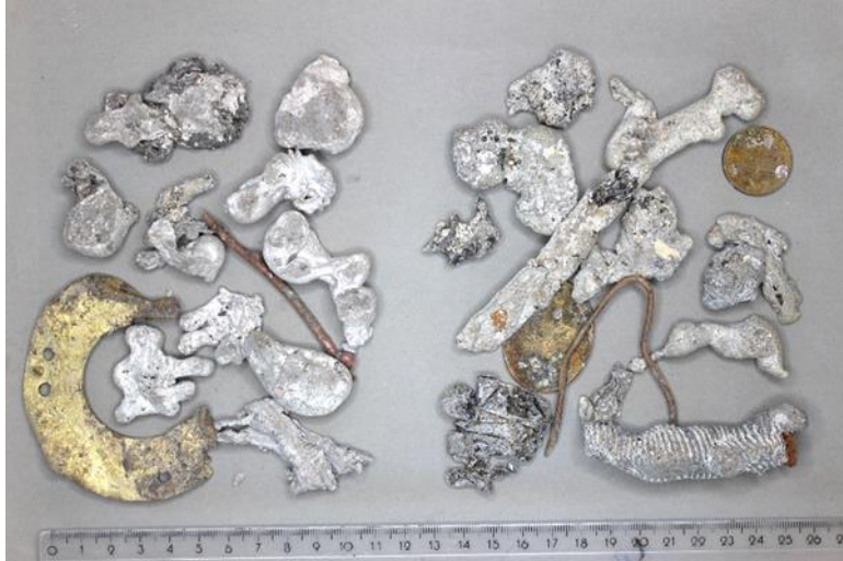
Abbildung 1: NE-Metall >16 mm im Vergleich. Links im Bild aus Trockenschlackenprobe (ERZ), rechts aus Nassschlackenprobe (Winterthur).
