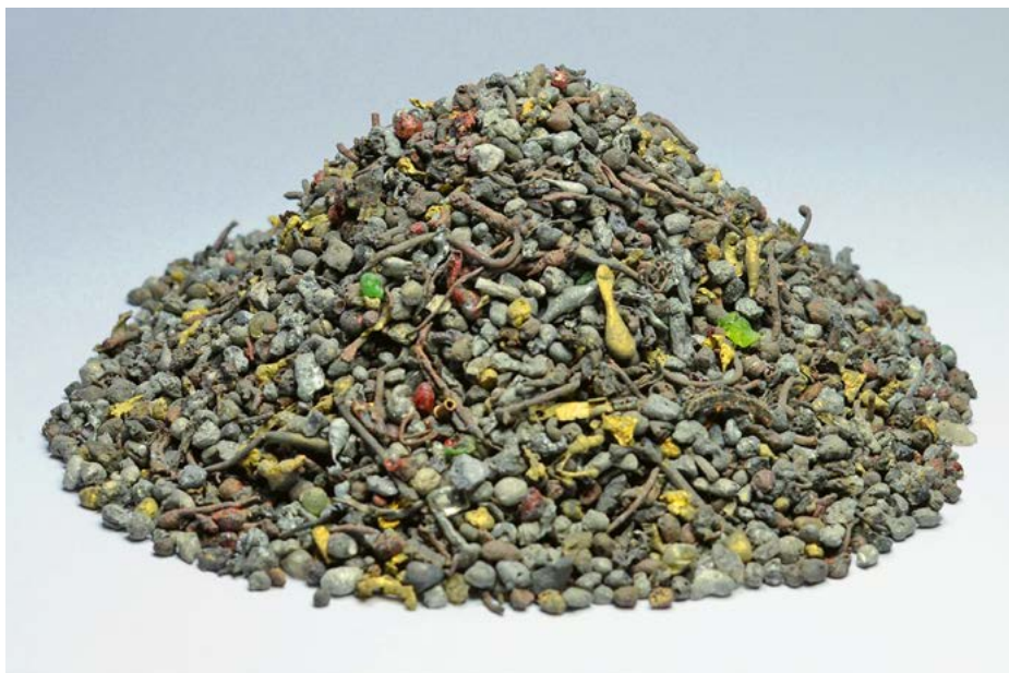
Insgesamt sorgt die Metallrückgewinnung in Hinwil für eine Umweltgutschrift von rund 780 kg CO 2 -eq pro Tonne Trockenschlacke. Im Bild: schwere Nichteisenfraktion, 5–8 mm. Foto: KEZO
