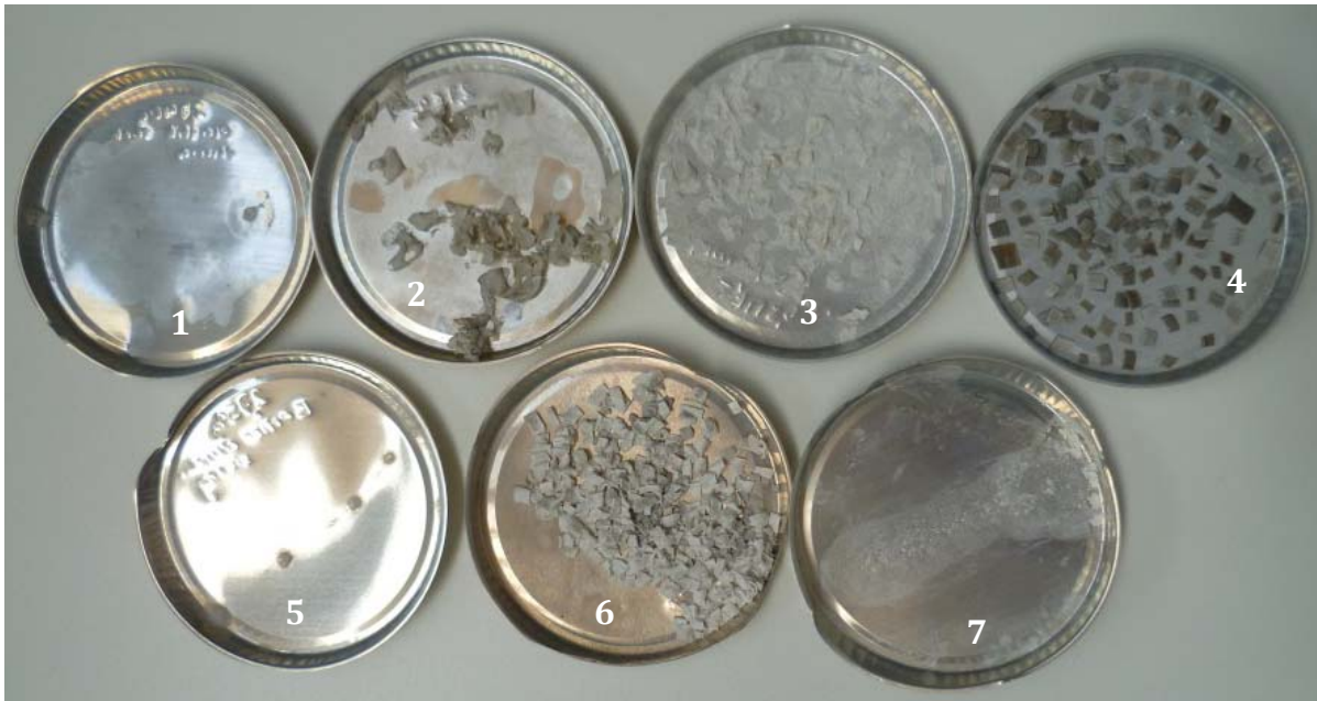
Abbildung 2: anorganischer Glührückstand nach glühen bei 550°C. 1= Plastiksack PLA, 2= Teller Zellstofffasern, 3= Becher Stärke beschichtet, 4= Teller Palmblatt, 5= Becher PLA, 6= Becher PE beschichtet, 7= MaterBi
