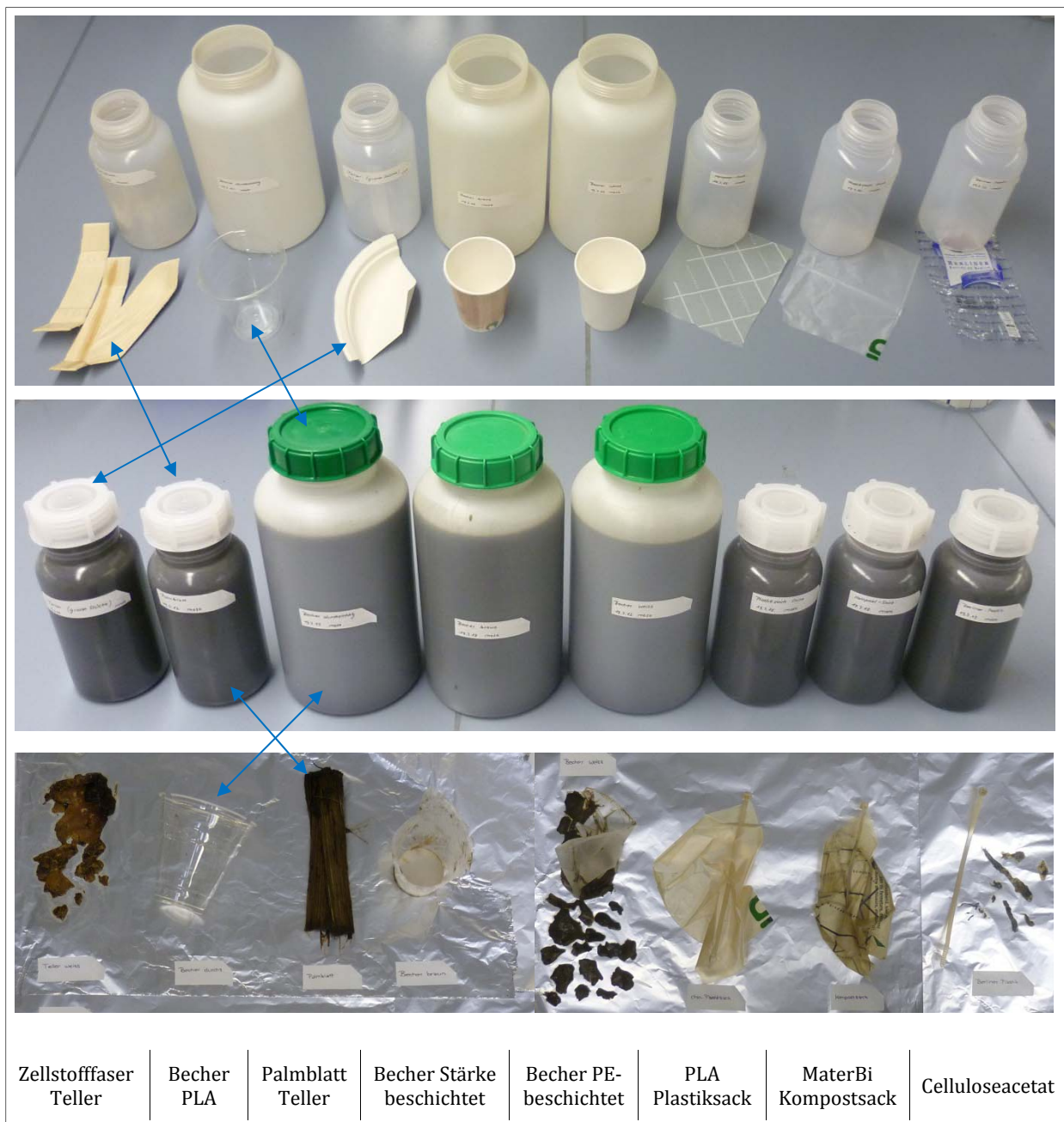
Abbildung 9: BAW Stücke vor dem anaeroben Abbaueversuch bei Raumtemperatur, während dem Versuch und nach dem Versuch. Die drei Folien wurden mit einem Kabelbinder aufgespiesst, damit sie nicht oben aufschwimmen und auch nicht zusammenkleben.
