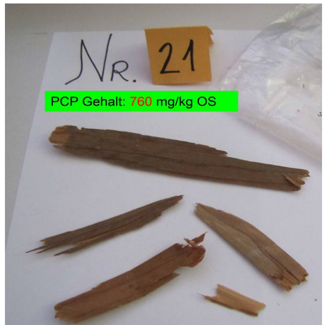
Abbildung 6: Foto Probe Nr. 21. Hoher PCP-Gehalt von 760 mg/kg.
