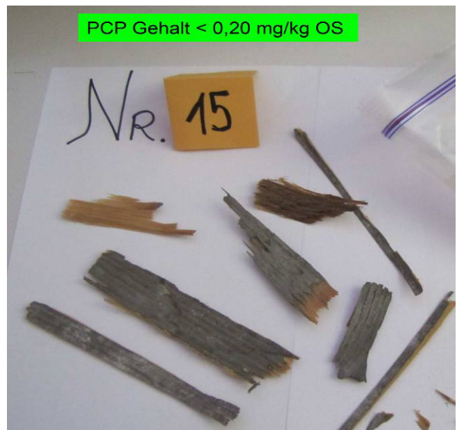
Abbildung 4: Foto der Probe Nr. 15. Tiefer PCP-Gehalten von < 0.2 mg/kg.
