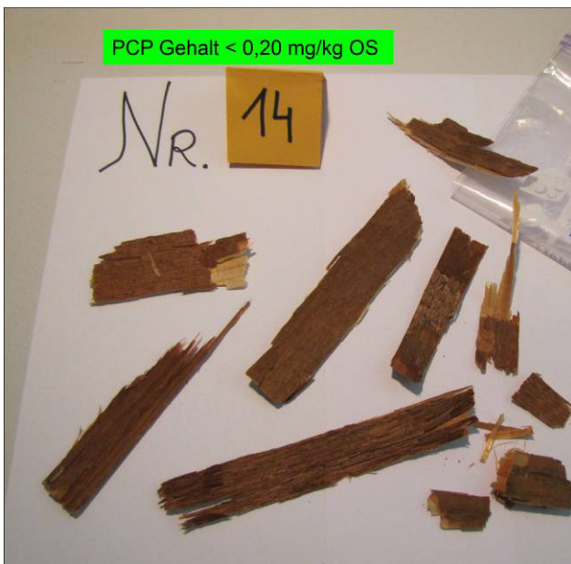
Abbildung 3: Foto der Probe Nr. 14. Tiefer PCP-Gehalten von < 0.2 mg/kg.
