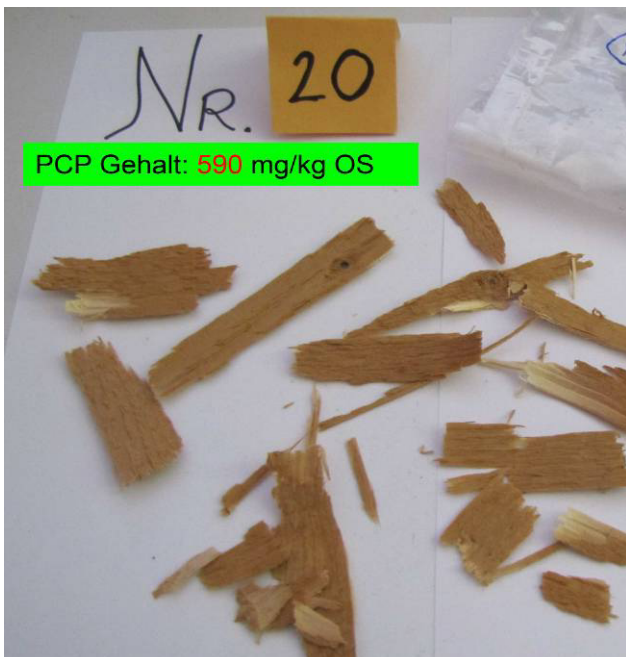
Abbildung 5: Foto Probe Nr. 20. Hoher PCP-Gehalt von 590 mg/kg.
