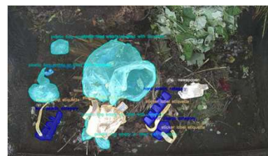
Abb. 19: KI kann mit normaler Kamera Fremdstoffe beim abkippen in den Sammelwagen erkennen
