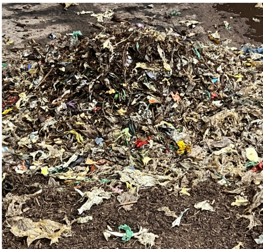
Foto 7: Plastikauslese mit Kompostroboter in Oetwil: Bei Fremdstoffauslese nach der Siebung liest der Kompostrobi noch viele Fremdstoffe aus. Leider erreicht man auch damit nicht 100% Plastikauslese.
