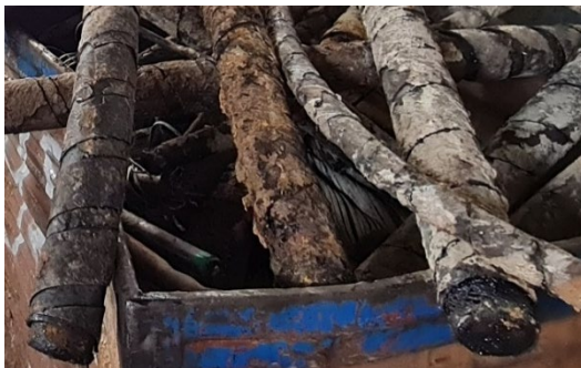
17 04 10 S Kabel mit Öl und Teerpappe
