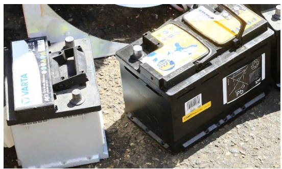
16 06 01 S Bleibatterien, ein Gefahrgut
