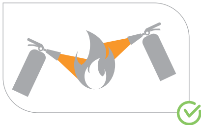
Abb. 31: Mehrere Feuerlöscher gleichzeitig einsetzen, nicht nacheinander!
