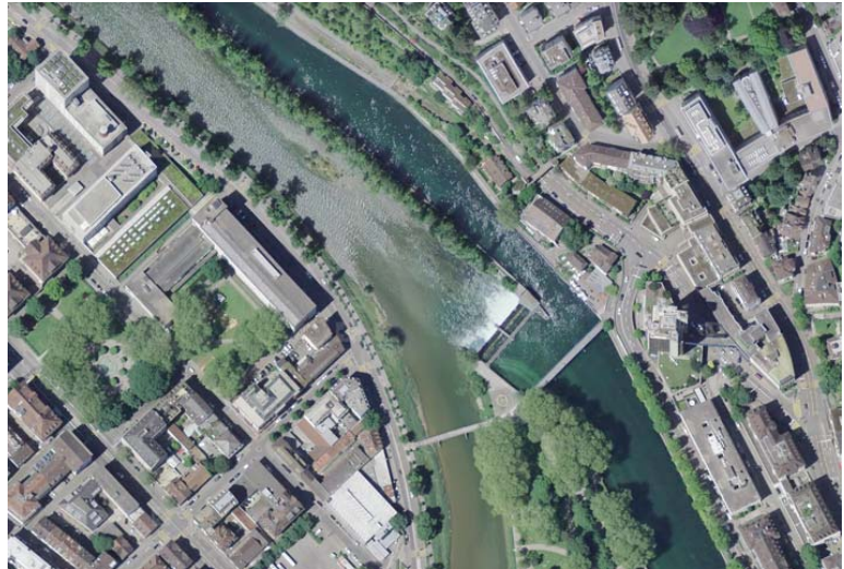
Bild A19 Dachwehr Letten mit Mündung Sihl (von links, trübes Wasser) und Oberwasserkanal (rechts). In der Restwasserstrecke besteht eine kleine Insel. Bundesamt für Landestopographie.
