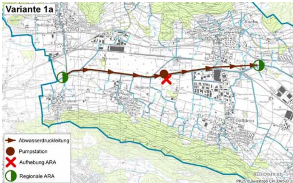
Abbildung 10: Variante 1a mit Aufhebung der ARA Furthof (Abwasserpumpleitung von der ARA Furthof zur ARA Wüeri), Zusammenlegung der Schlammwasserbehandlung auf der ARA Wüeri (Pumpen des Schlammwassers ab der ARA unteres Furttal)
