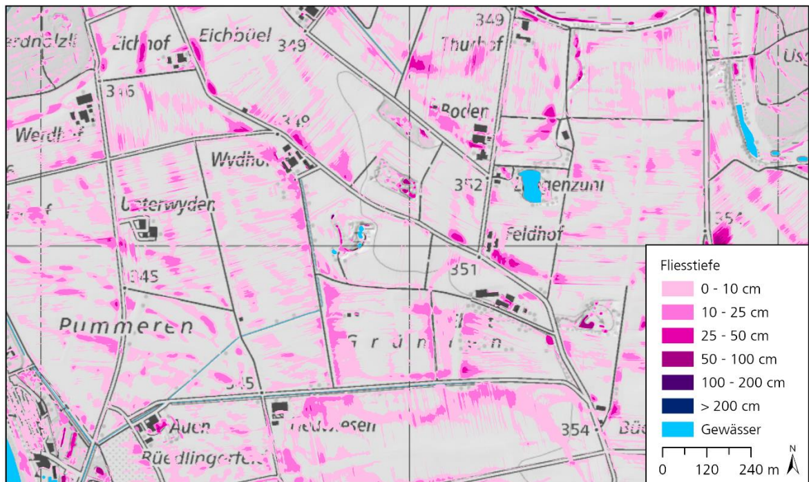
Abbildung 23: Im Terrainmodell abgebildete Ackerstrukturen beeinflussen die Fliesswege des Oberflächenabfluss. Hier ein Beispiel bei Flaach für ein 100-jährliches Ereignis (Quelle Kartenhintergrund: Landeskarten und Hillshade, Bundesamt für Landestopografie).
