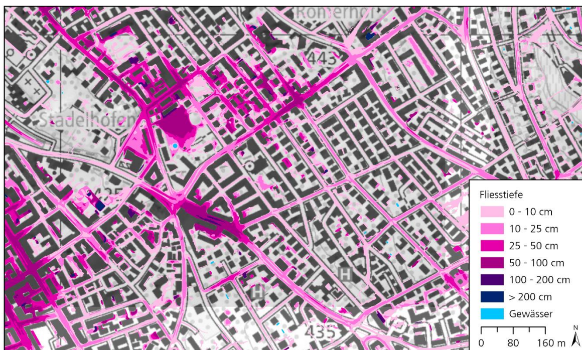
Abbildung 17: In Siedlungszentren ist die Genauigkeit der Hinweiskarte Oberflächenabfluss limitiert, da zahlreiche Kleinstrukturen, welche die Abflusswege beeinflussen können, im Terrainmodell nur sehr beschränkt abgebildet sind. Das Bild zeigt einen Ausschnitt aus der Stadt Zürich für das 100-jährliche Ereignis (Quelle Kartenhintergrund: Landeskarten und Hillshade, Bundesamt für Landestopografie).
