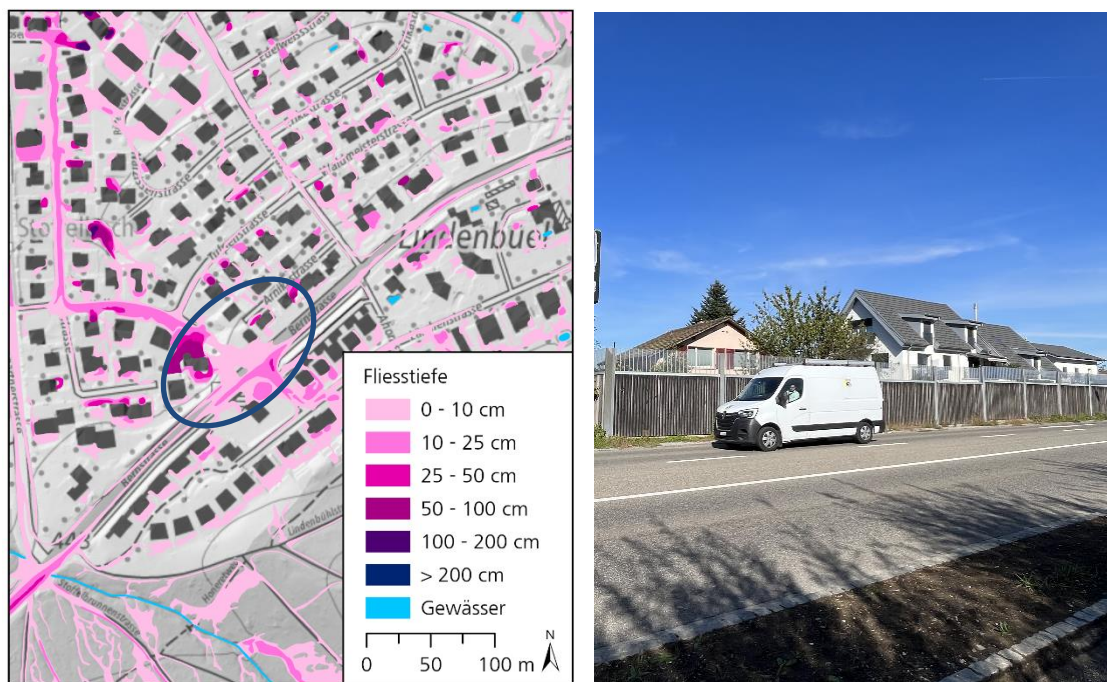
Abbildung 16: Nicht erfasste Kleinstrukturen wie hier eine Lärmschutzwand in Dietikon (rechts), führen zu Fliesswegen im Modell, welche nicht mit der Realität übereinstimmen (links, blau umrandet) (Quelle Kartenhintergrund: Landeskarten und Hillshade, Bundesamt für Landestopografie; Quelle Foto: geo7 AG).
