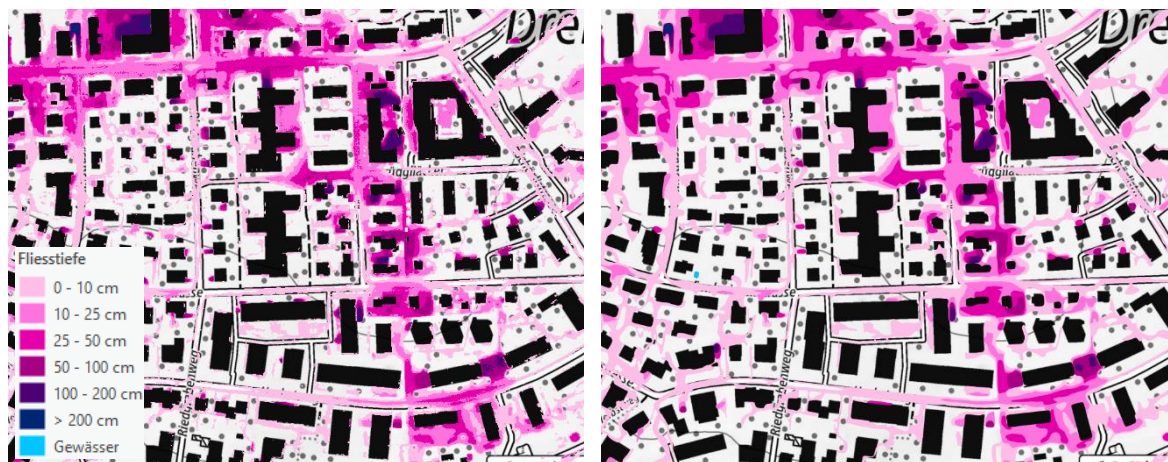
Abbildung 9: Ausschnitt des Rohresultats (links) und des aufbereiteten und kleinflächenbereinigten Endproduktes (rechts) für ein 100-jährliches Ereignis bei Oerlikon. (Quelle Kartenhintergrund: Landeskarte (grau), Bundesamt für Landestopografie).
