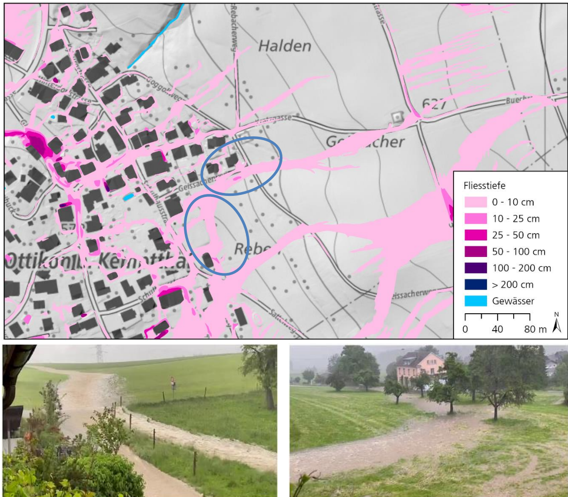
Abbildung 15: Hinweiskarte Oberflächenabfluss und vergangenes Ereignis (07.06.2021) bei Ottikon bei Kempththal, Gemeinde Illnau-Effretikon (Quelle Kartenhintergrund: Landeskarten und Hillshade, Bundesamt für Landestopografie; Quelle Fotos: Augenzeuge).
