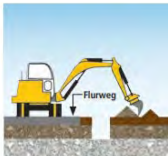
Abbildung 6 – Standort Bagger für die Grabenverfüllung und den Leitungseinbau
