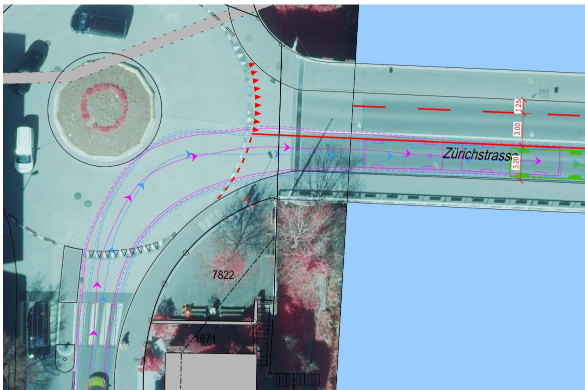
Abb. 28 / Schleppkurven LKW A aus der Albisstrasse auf die Bahnhofbrücke (Zürichstrasse)
