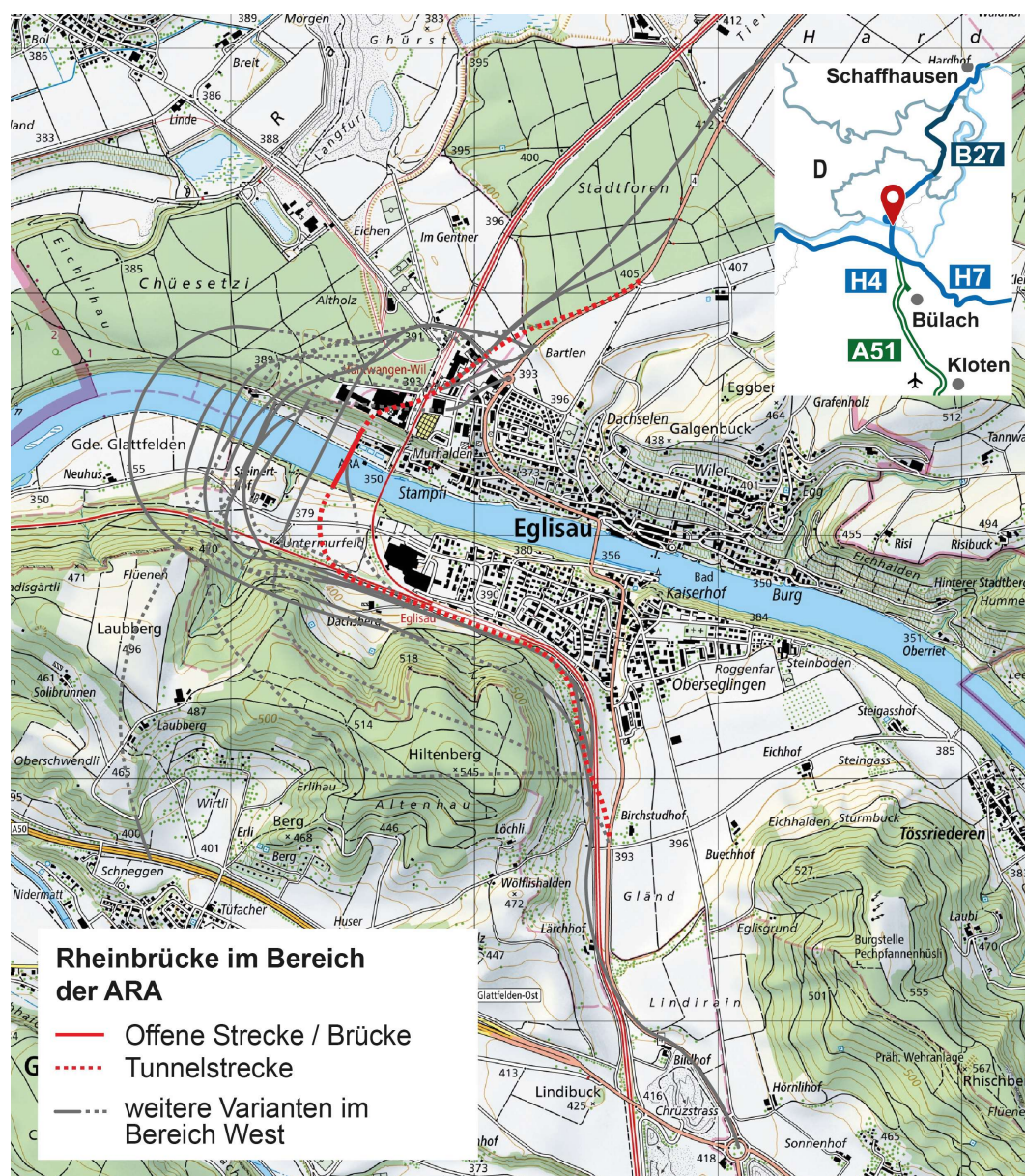
Abbildung 55 Situation Variante ARA (Quelle: Tiefbauamt Kanton Zürich)
