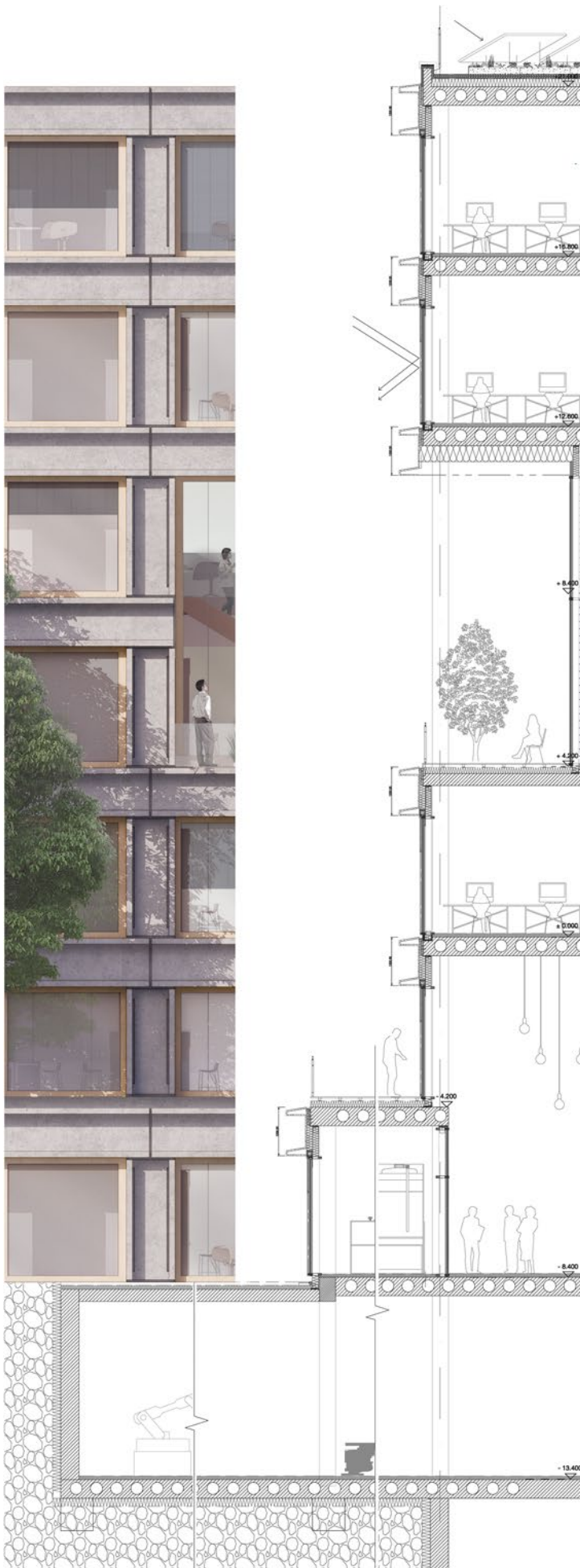
Konstruktionsschnitt mit Teilansicht Fassade, Laborbau 1:150
