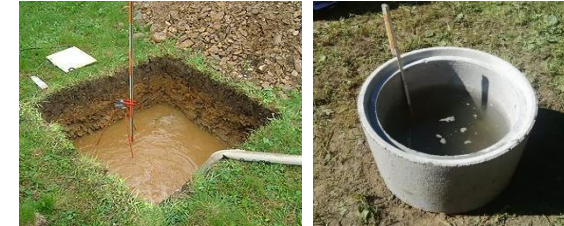
Einfache Versickerungsversuche für oberirdische Versickerungsanlagen (Begleitung durch Fachperson, siehe Vortrag P. Gander)
