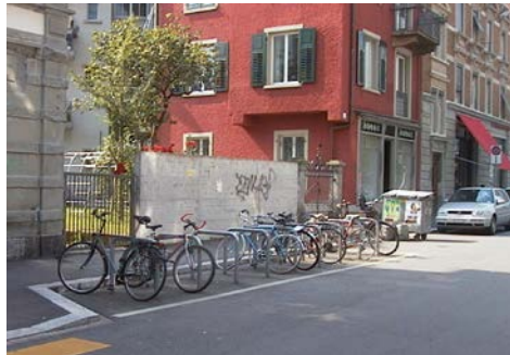
Ungedeckte Veloparkierung im Strassenraum, Velorahmen abschliessbar: geeignet für Kurzzeitparkieren von BewohnerInnen und BesuchernInnen.
