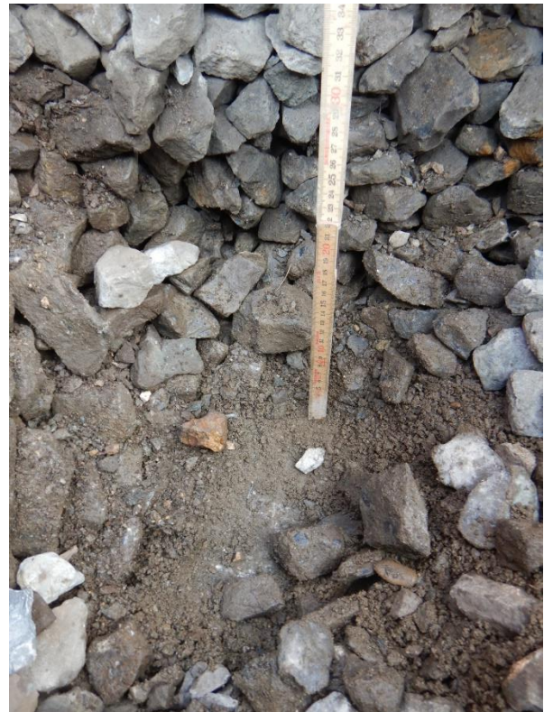
Abb. 4 – Gleis 118, km 19.397: starrer Unterbau «Meilibach-Brücke» Profil durchs Schotterbett: S1-2 – gering bis mittelmässig mit Betriebsschmutz und Schotterabrieb verunreinigt, die Körner sind im mittleren Grade zerbrochen, stopf- und reinigbar
