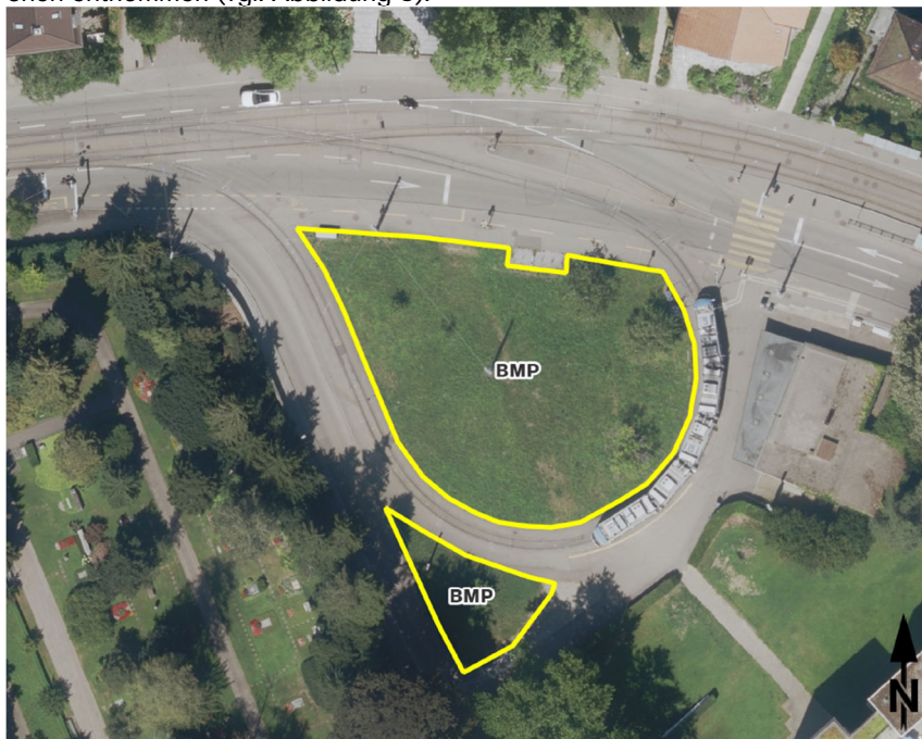
Abbildung 3 - Probenahme Flächenmischprobe (BMP) innerhalb gelb markierter Fläche; nicht massstäblich, genordet.
