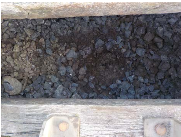
Bild 5: W 24, km 5.959: Blick in den Aufschluss, der Unterbau besteht aus leicht siltigem Kies mit Sand und Steinen (Bodengruppe GP-GM, Schichtdicke mindestens 34 cm)
