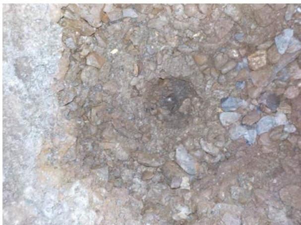
Bild 9: W 24, km 6.002, Ablenkung: Blick in den Aufschluss, der Unterbau besteht zunächst aus Grobkies und Schotter/Steinen (Schichtdicke 18 cm), darunter folgt leicht siltiger Kies mit wenig Sand (Bodengr. GP-GM)
