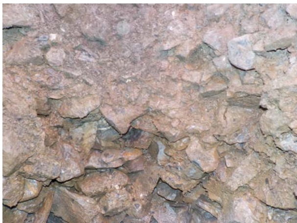
Bild 15: W 29, km 5.960, Hauptstrang: Schotter in den Schienenbereichen mittelmäßig bis stark (S2-S3) verschmutzt, gerade noch wirksam reinigbar, Stopfbarkeit allerdings bereits deutlich eingeschränkt
