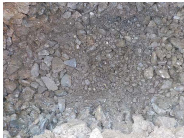
Bild 16: W 29, km 5.960, Hauptstrang: Blick in den Aufschluss, der Unterbau besteht aus leicht siltigem Kies mit wenig Sand und einzelnen Steinen (Bodengruppe GP-GM, Schichtdicke mindestens 24 cm)
