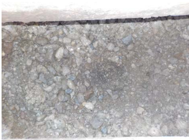
Bild 7: W 24, km 6.002, Hauptstrang: Blick in den Aufschluss, der Unterbau besteht zunächst aus Grobkies und Schotter/Steinen (Schichtdicke 27 cm), darunter folgt leicht siltiger Kies mit wenig Sand (Bodengr. GP-GM)
