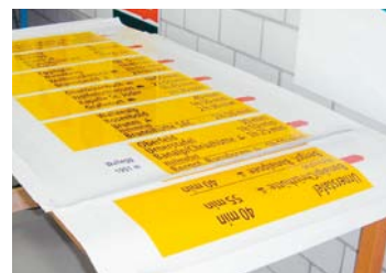
Abb. 21 Digitaldruck: Farbpulver oder -tinte wird auf eine Folie aufgetragen. Diese wird anschliessend auf den Wegweiser geklebt.
