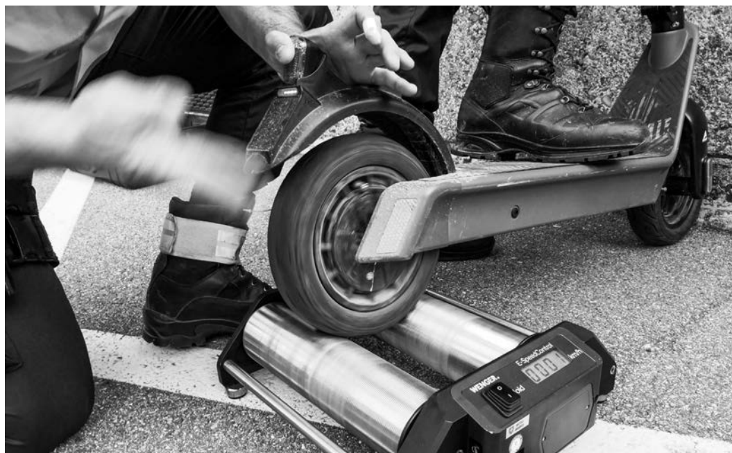
Bei der Kontrolle von fahrzeugähnlichen Geräten wie E-Trottinets greifen die Polizistinnen und Polizisten auf handliche Einsatzmittel wie diesen Geschwindigkeitsmesser zurück.
