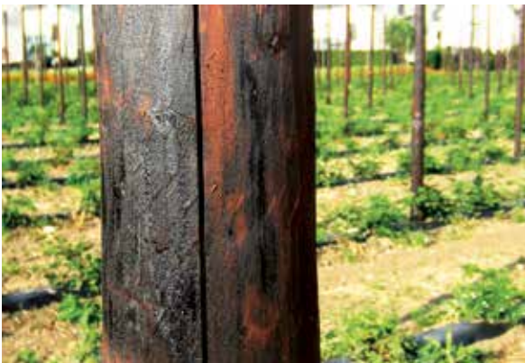
Abb. 8.3.1: Mit Teeröl behandelte Holzpfähle
