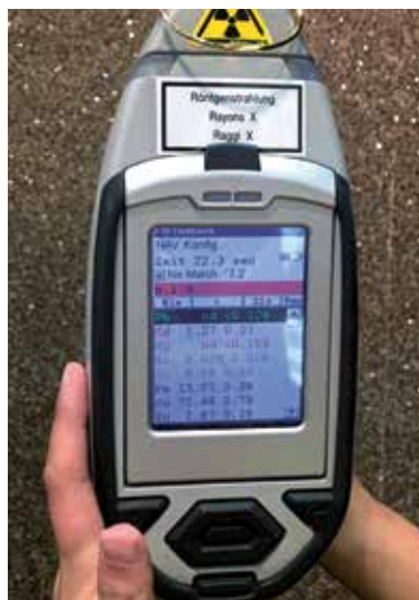
Abb. 6.2.5: Der Cadmiumgehalt beträgt beim Bügel des Ohrhings 1.27 Gew. %.
