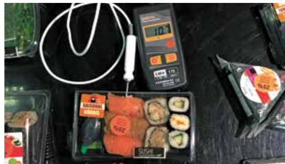
Abb. 6.2.9: Messung der Produkttemperatur in einem Produkt mit der Vorgabe von 5°C und einer effektiven Produkttemperatur von 10.7°C.
