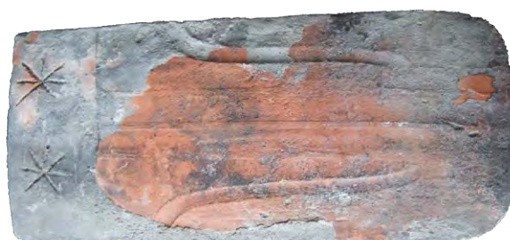
Handgestrichener Biberschwanzziegel mit Rillen, die das Wasser vom Rand abweisen (Abb. 83)
