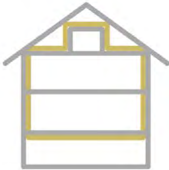
Dachausbau mit autonomer gedämmter Hülle
