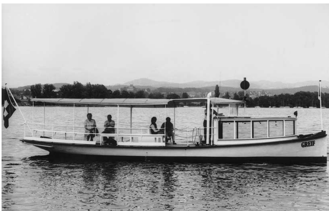
Rechts: Steuerbordseite des Schraubendampfschiffes «GREIF» nach dem Umbau zum Motorschiff (1916) und der Veränderung der Vorschiffkabine (1950). Zustand nach 1950, historische Photo.
