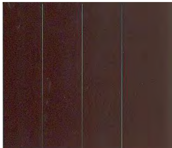
Dünnschichtzelle aus amorphem Silizium (Abb. 17)
