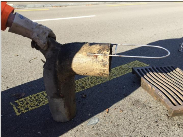
Abbildung 26: Auf Tauchbogen aufgeklemmter Ansaugschutz
