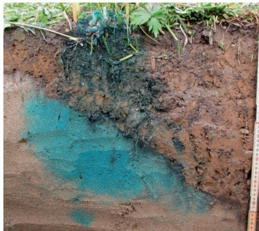
**Abbildung 9:** Fliessmuster und Ablagerungen von Pneumabtrieb im Filter einer SABA, in der Bodenmaterial oberhalb einer schräg verlaufenden Sandschicht eingebaut wurde (Pazeller et al., 2017).
