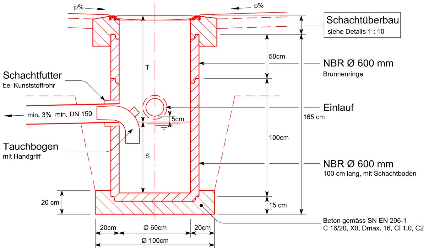
T = Auslaufsohle unter fertiger Rosthöhe: normal 90 cm, min. 75 cm
