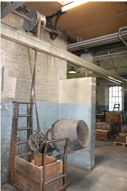
Maschinenpark, Putztrommel mit Transmissionssystem
